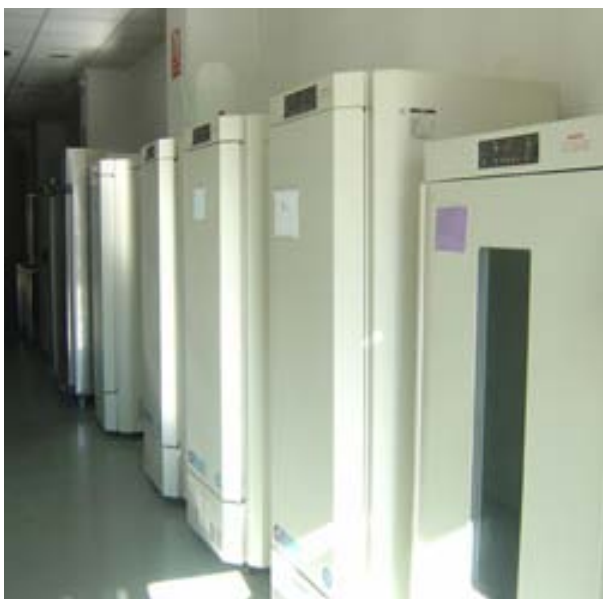
Batería de cámaras germinadoras del Banco de Germoplasma del CIEF.
