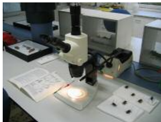
Fig. 1.- Lupa triocular del laboratorio de Sanidad Forestal (CIEF).
