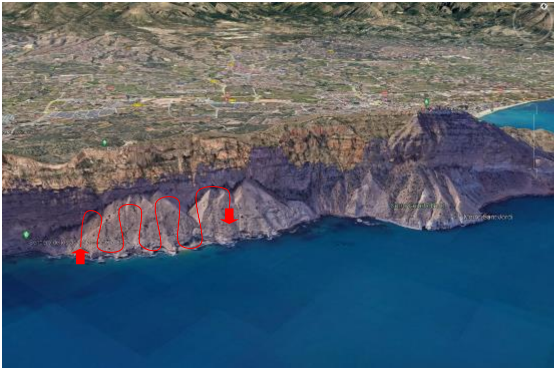
Figura 5. Método de vuelo del dron en zigzag para la realización de imágenes. Sector norte del acantilado litoral de Serra Gelada. Esta zona abarca aproximadamente desde el Faro del Albir hasta la Illa Mitjana.
