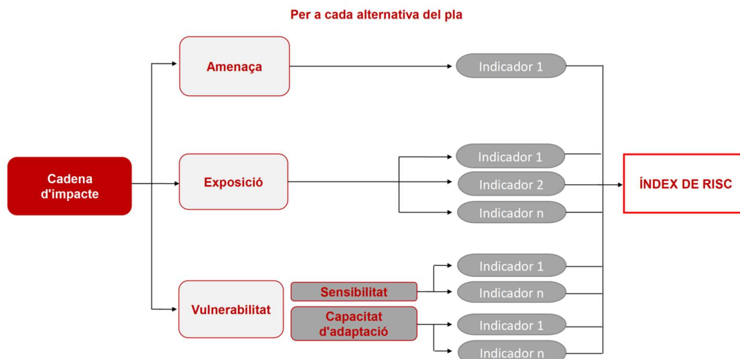
Figura 11: Metodologia de càlcul de l'índex d'adaptació per a cada alternativa. Font: (IDOM Consulting, Engineering, Architecture)
