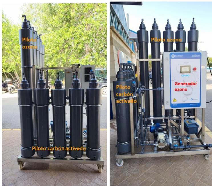
Figura 3. Plantas piloto y generador de ozono montadas sobre estructura (elaboración propia)
