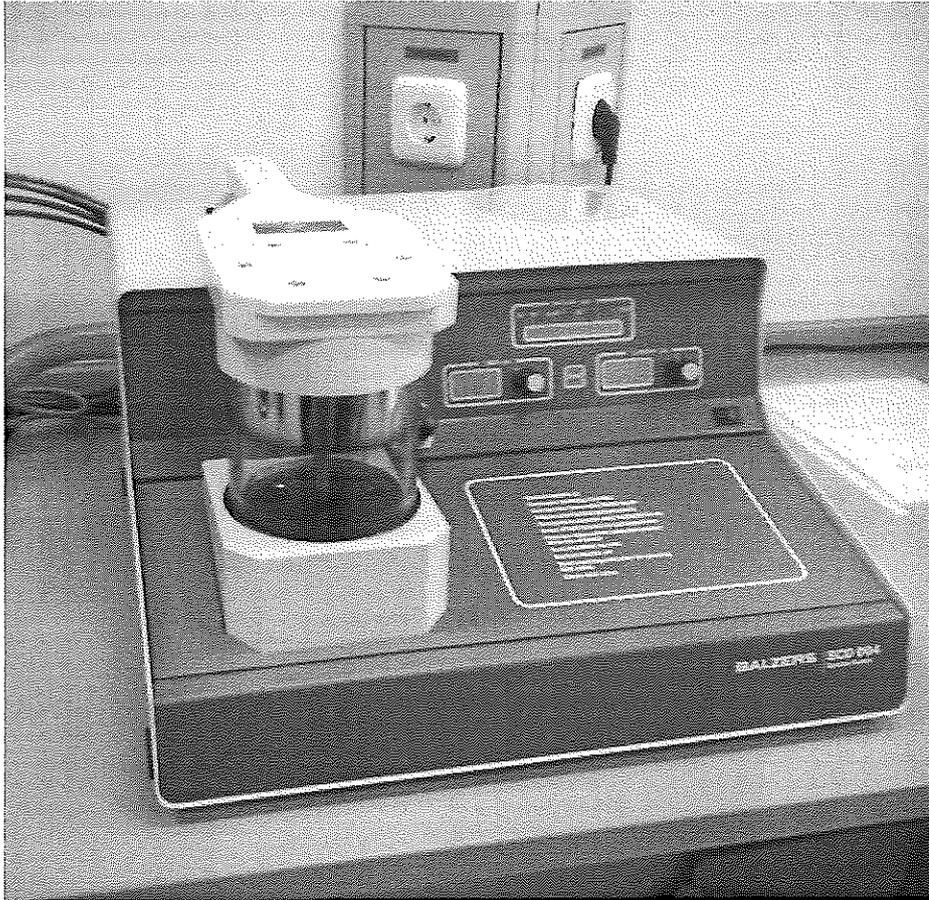
**Figura 9:** Metalizador para recubrir las muestras de oro
