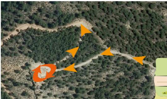
**Caso 1.** La curvatura del vial impide realizar el giro sin maniobra, si el terreno lo permite se puede habilitar una zona de giro tipo rotonda.
