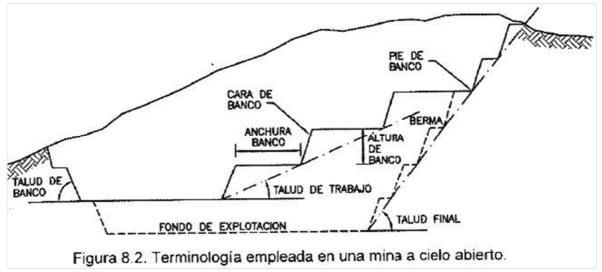
Figure (6). Standard profile of surface mining operation. (Manual de Evaluación y Diseño de explotaciones mineras. Bustillo Revuelta & López Jimeno)
