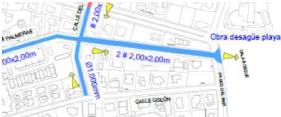
Plano de planta de red de pluviales.
