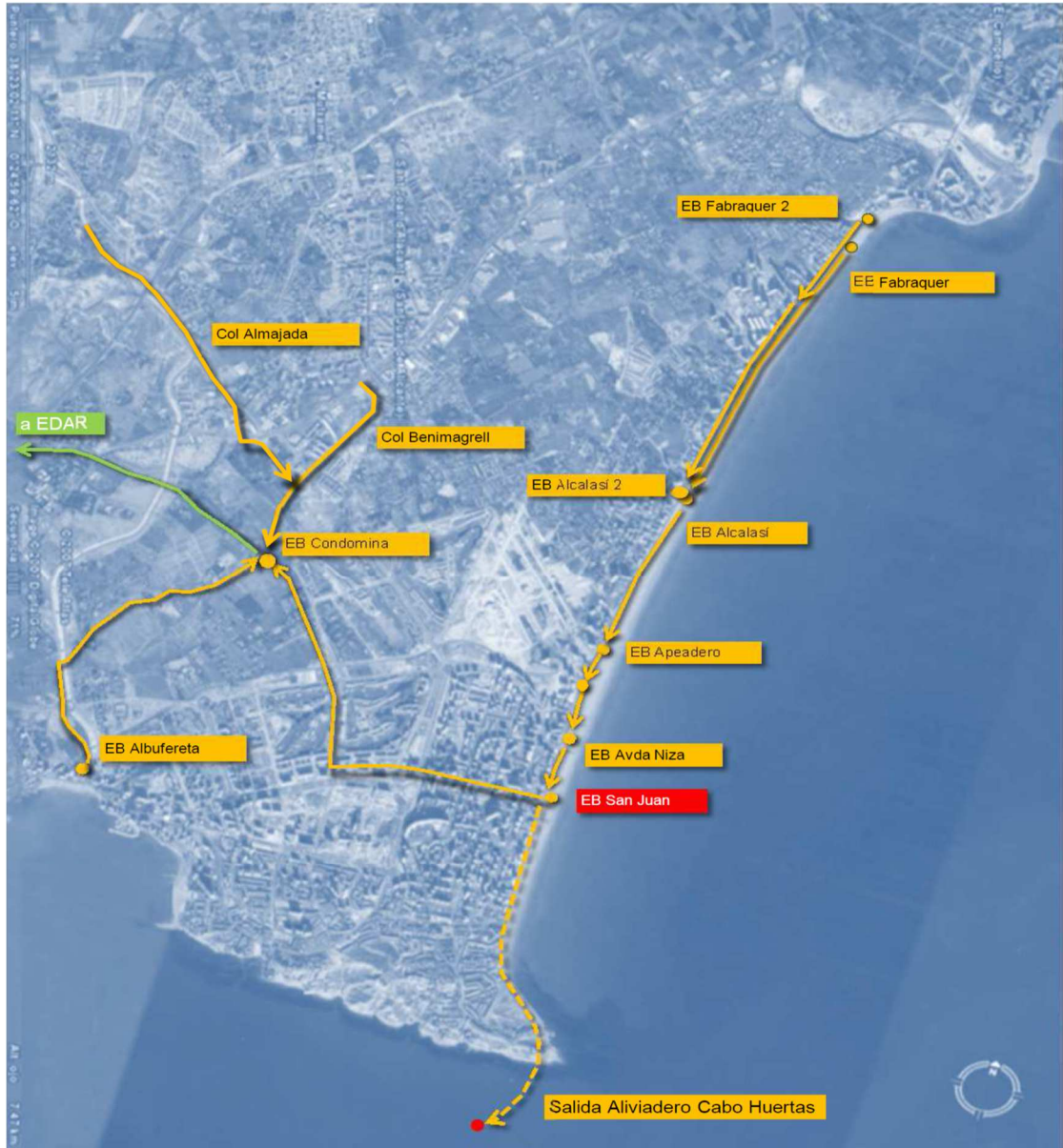
Red de saneamiento asociada al aliviadero de emergencia de Cabo de las Huertas
